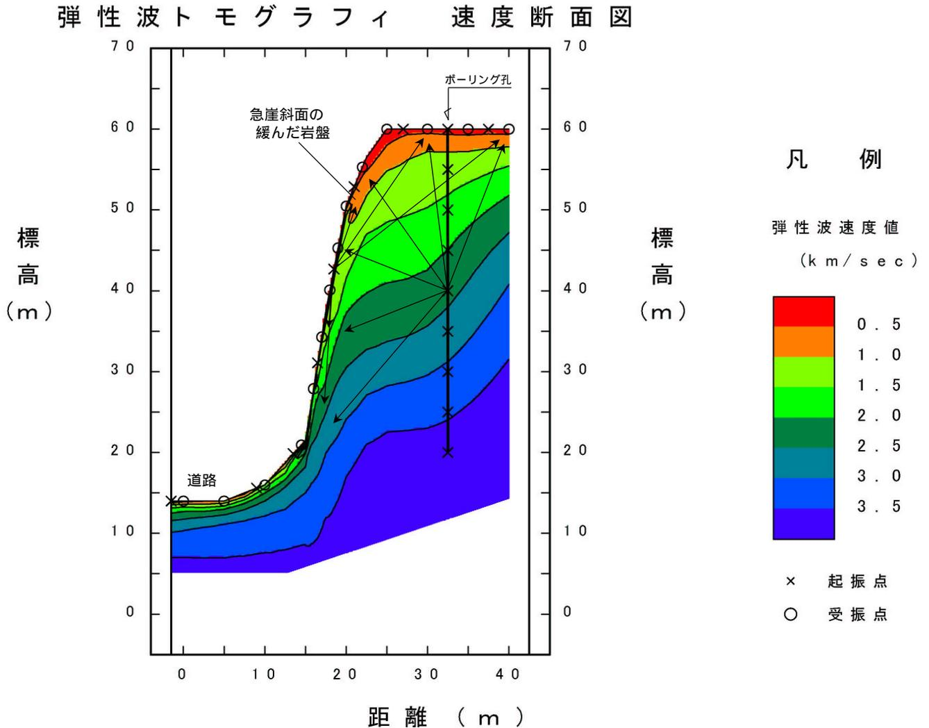
地表とボーリング孔を利用して探査対象領域を取り囲むように起振点や受振点を配置し測定を行う。
